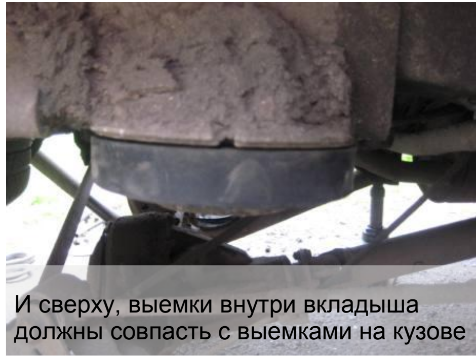
Устанавливаем новые вкладыши снизу
